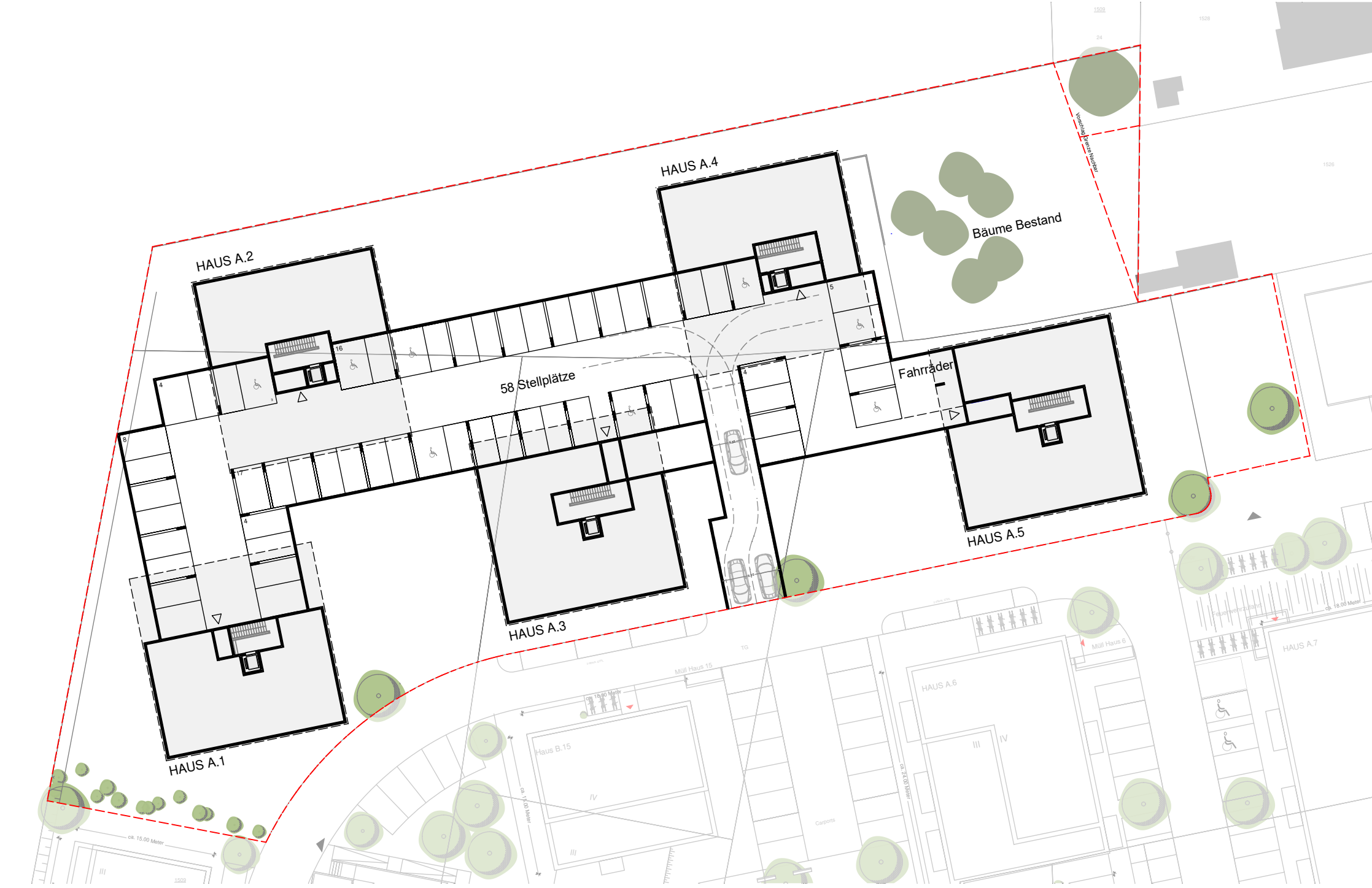
Baufeld A1_Häuser A.1-A.5_Tiefgarage_M 1:500
