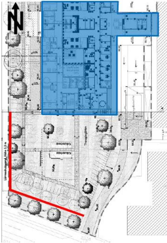
Abbildung 8: Position Lärmschutzwand aus Lärmschutzgutachten / Stand 10.12.2020
