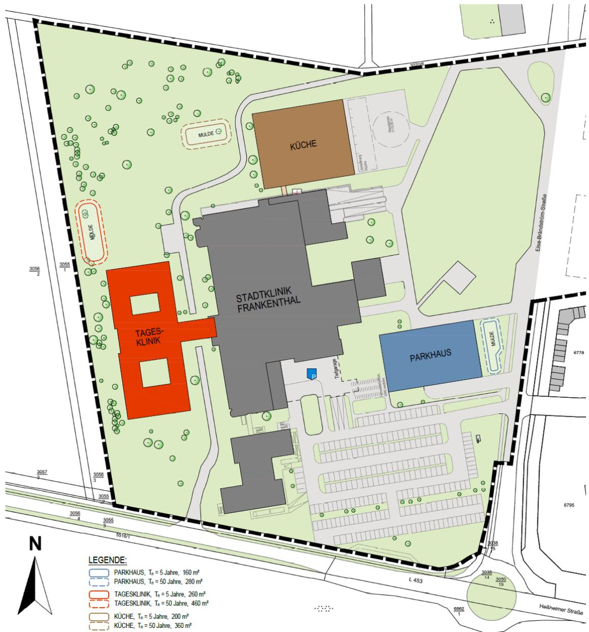
Abbildung 3.4: Mögliche Verortung der Muldenversickerungsanlagen
