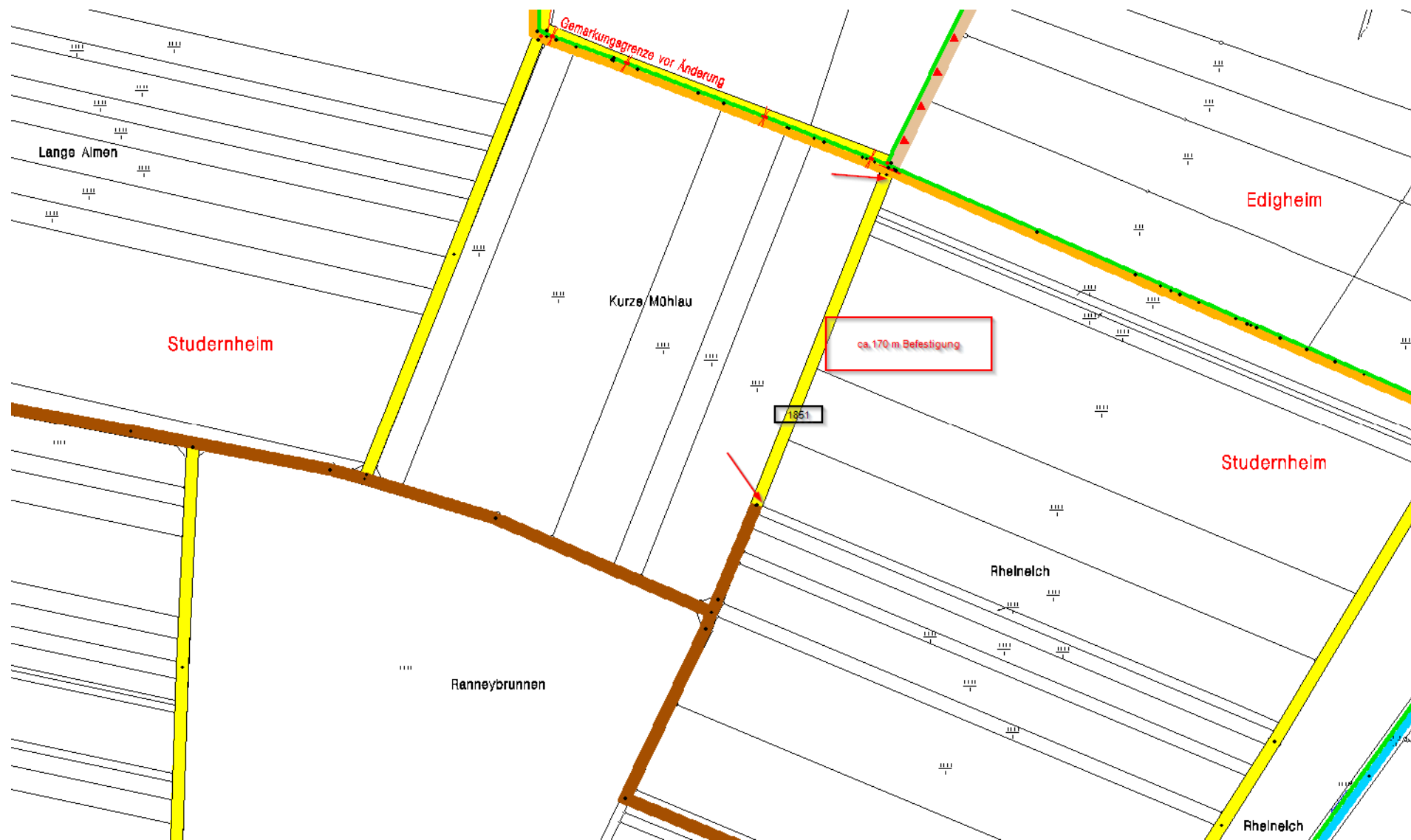
Weg, Gemarkung Studernheim, Flurst.Nr. 1851, ca. 170 m Befestigung in Bitumenbauweise
