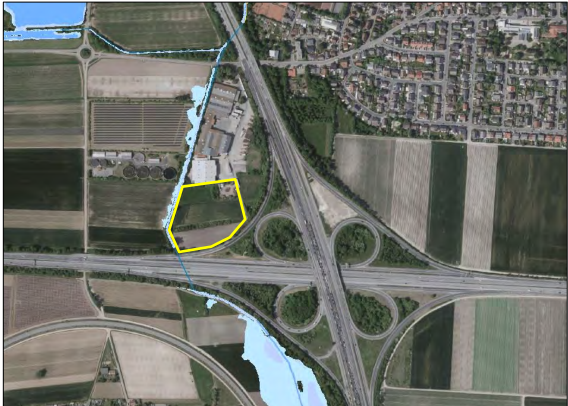
Überflutungsfläche eines 100-jährlichen Hochwasserereignisses HQ 100 (blau flächig) im Südwesten der Ortslage von Beindersheim. Das Bebauungsplangebiet ist gelb umrandet. (Quelle: Geoportal Wasser der Wasserwirtschaftsverwaltung Rheinland-Pfalz; Hochwassergefahrenkarte)
