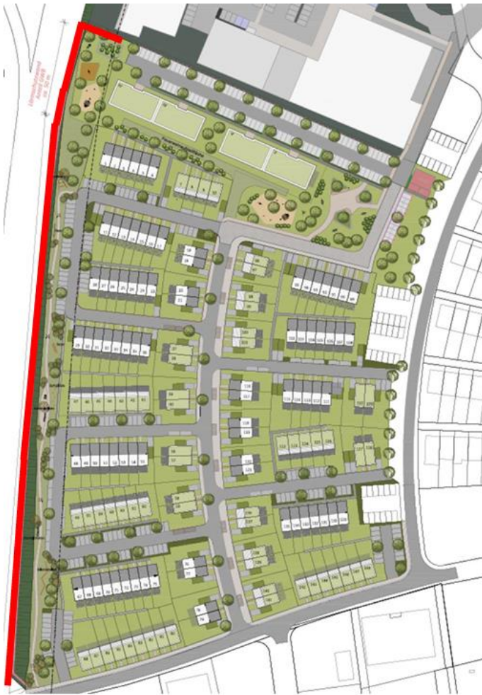
Abb.: Verortung der Lärmschutzwand, Quelle: Schalltechnisches Gutachten zum Bebauungsplan, Büro Gerlinger + Merkle Ingenieurgesellschaft für Akustik und Bauphysik mbH, Werderstraße 42, 73614 Schorndorf, S. 44.
