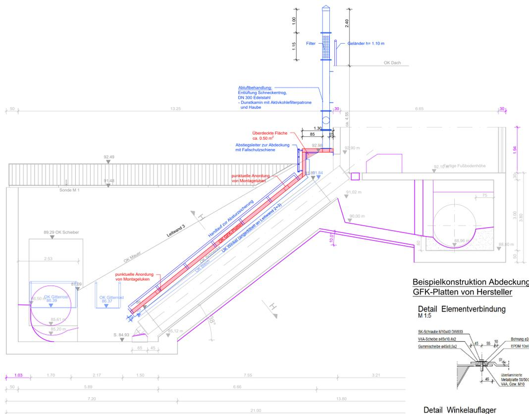
Beispielkonstruktion Abdeckung GFK-Platten von Hersteller
