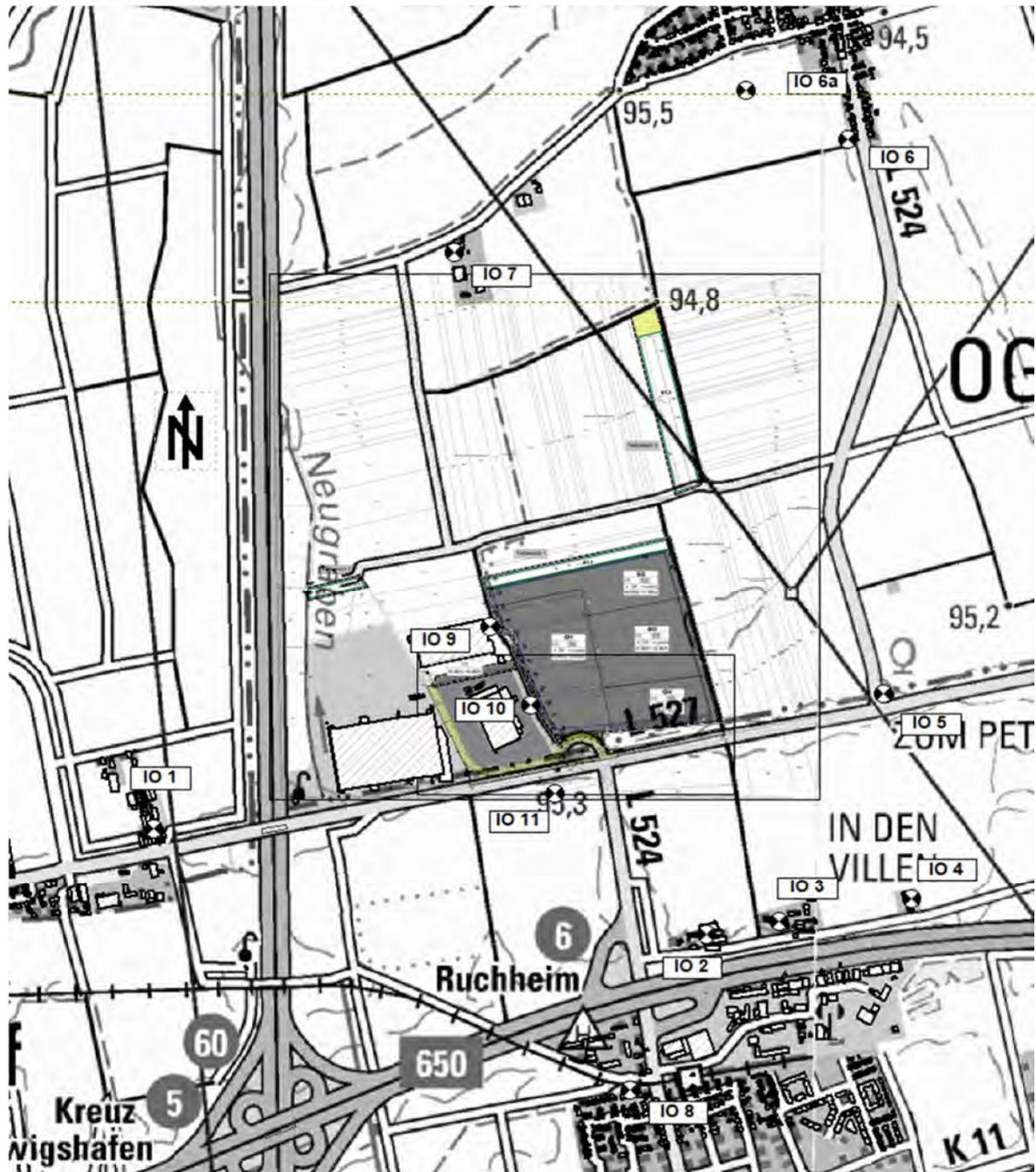
Bild 5: Ausschnitt aus dem digitalen Geländemodell mit Darstellung der Immissionsorte außerhalb des Plangebiets
